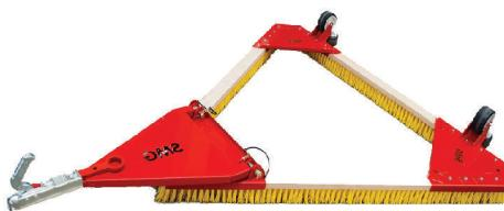
۲- برس دوار چرخشی: این برس به جلوی کشنده متصل می شود و در بلند کردن الیاف چمن و حفظ حالت ایستایی آن نقش موثری دارد.(استفاده از این برس اختیاری است)
